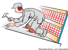
Skyddsräcke vid takarbete
